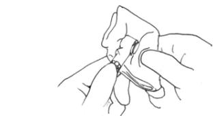
Limpie el instrumento manual con una gasa empapada en etanol para desinfección (etanol al 70 u 80 %).
