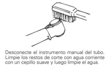
Desconecte el instrumento manual del tubo. Limpie los restos de corte con agua corriente con un cepillo suave y luego limpie el agua.
