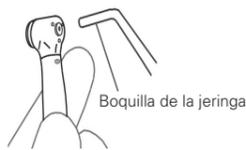
Después de la limpieza, limpie el orificio del pulverizador con aire de la jeringa o con un método similar.
