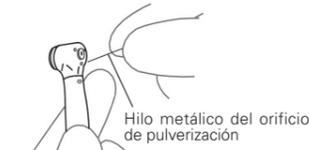
Limpie el orificio del pulverizador con el alambre para orificios proporcionado.
